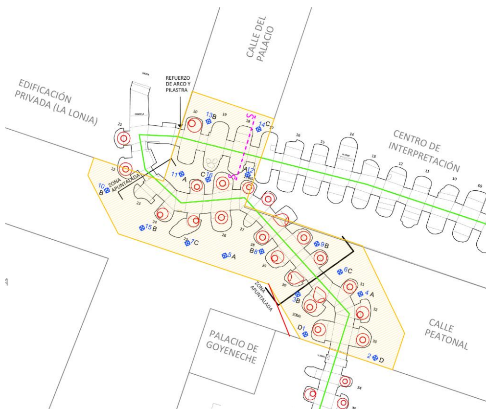
Figura 19. Extensión de la losa y posición prevista para los micropilotes
